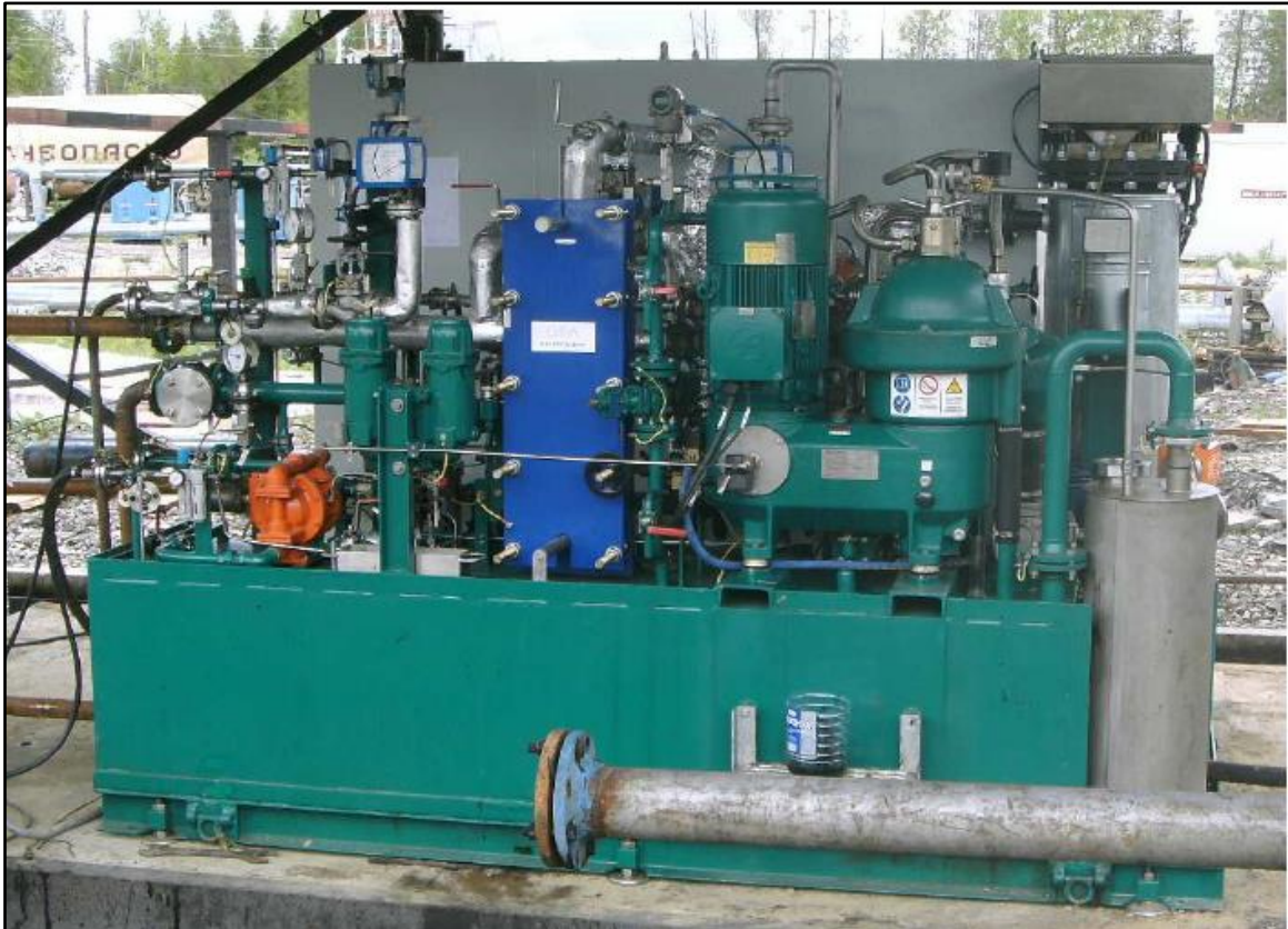
Figura 5. Tecnología de deshidratación de crudos pesados por centrifugación (Perschke, 2013).
